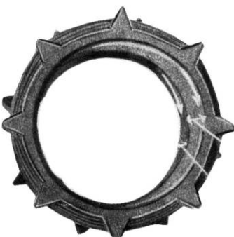
Abb. 11. Bei Langwellenspulen darf man sich „wilde Wicklung“ leisten; hier wurde Rippenrohr als Spulenkörper verwendet, in das Nuten eingefeilt sind.
